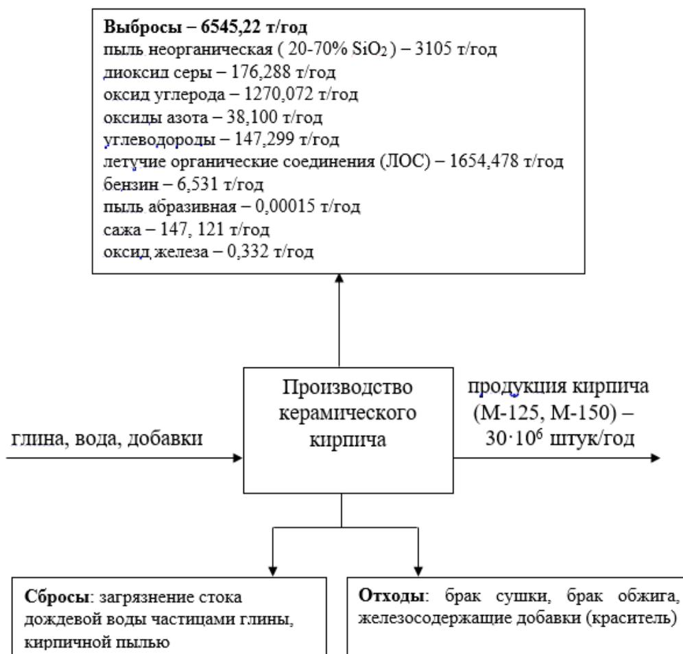
Рисунок 1 - Баланс входных и выходных материальных потоков воздействия кирпичного завода на окружающую среду
