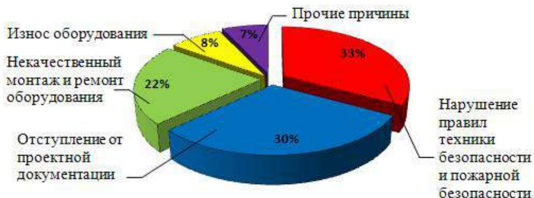
Рисунок 3 – Обобщенные причины аварий на объектах нефтегазового профиля
